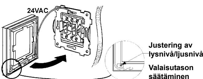
**N:** Termineringskabeln plugges til bakrammen med dekorlys. Monter rammen - påse at termineringskabeln ikke kommer i klem. Lyskilden skal monteres nede.
