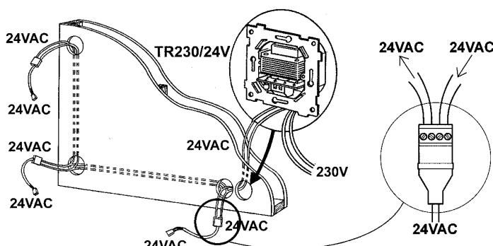
**N:** Felles trafo art.nr 4033 kobles og monteres i separat veggoks. 24V Ledninger fordeles/trekkes til maks 10 bakrammer med lys. Bruk termineringskabel EW048 i hver boks.
